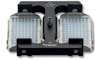
max. volume: 2 x 1 microtitre plates Order number.: 221.77 V01
